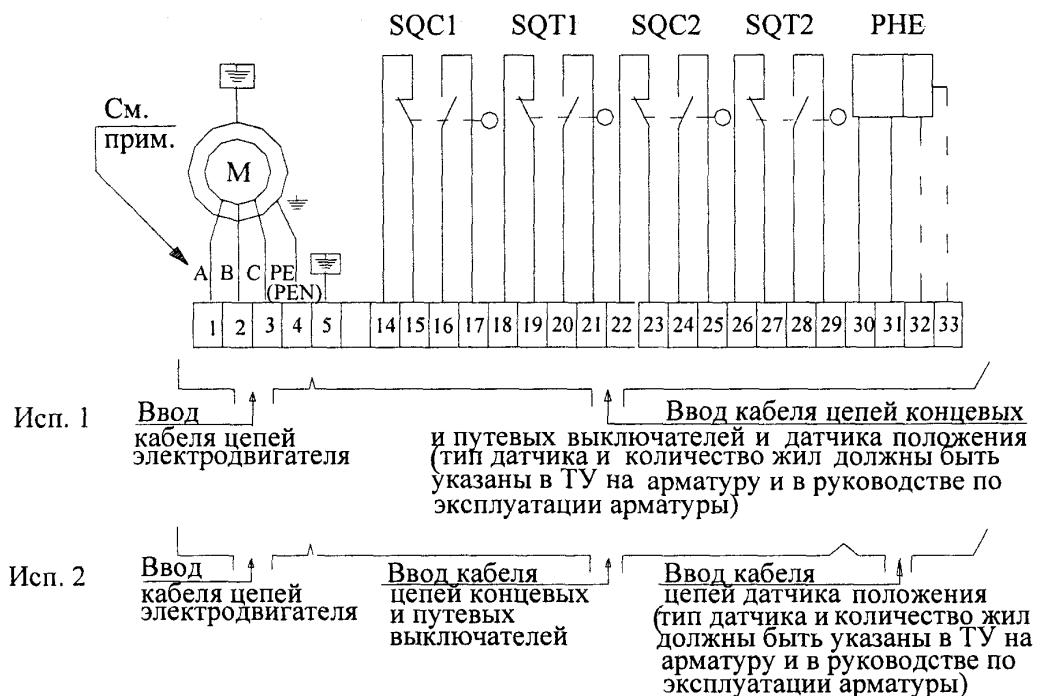
M-электродвигатель одно- или трехфазный асинхронный
