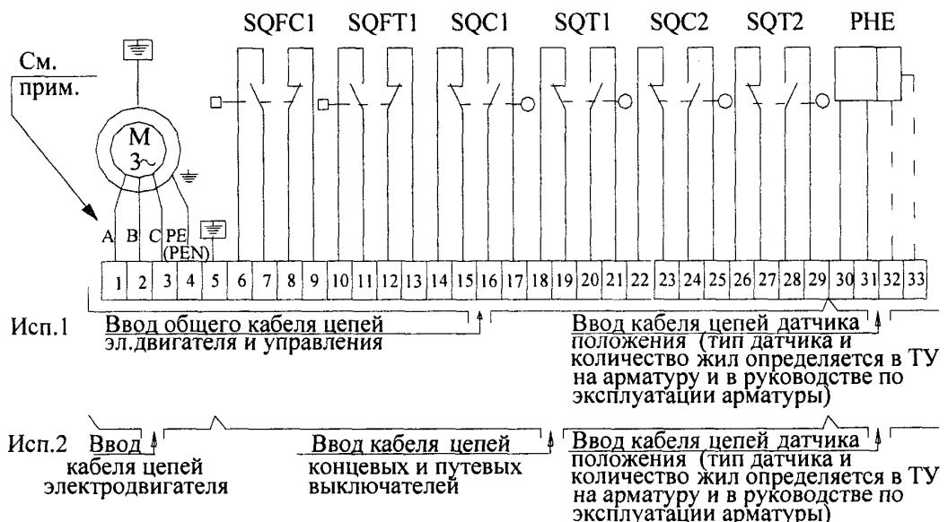
М-электродвигатель трехфазный асинхронный
