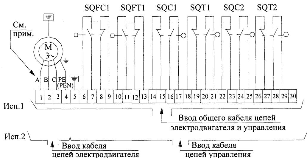
М-электродвигатель трехфазный асинхронный
